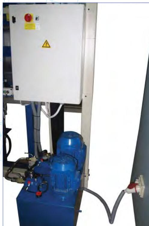
Figure 20. Tableau de contrôle électrique.
