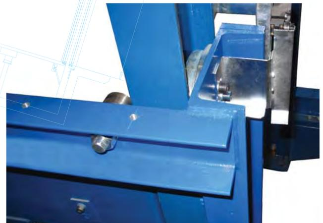
Figure 6. Guidage latéral, 4 roulements par châssis.
