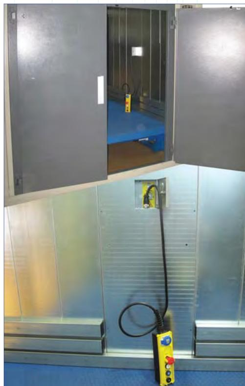
Figure 22. Boîte à boutons branchée sur parement.
