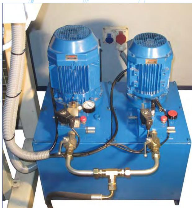
Figure 17. Centrale hydraulique.
