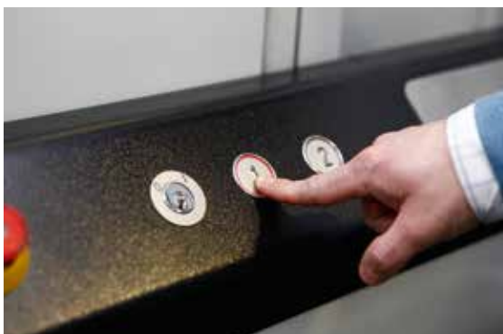
Clavier avec clé d'habilitation et arrêt d'urgence
